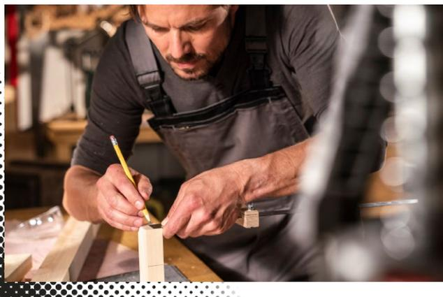
Jetzt bohrst Du in jede Leiste, die hinten an die Regalböden kommt, je drei Löcher. Hier wird das Regal später an die Wand gedübelt. Dann folgen vier Bohrungen in der unteren Leistenhälfte, um sie am Regalboden anzuschrauben.
