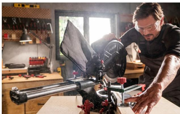
Jetzt schneidest Du beide Seiten der langen Leisten im 45°-Winkel ab. Dasselbe machst Du mit den hinteren Seiten der kurzen Leisten. Das ist die Seite, die später zur Wand zeigt.
