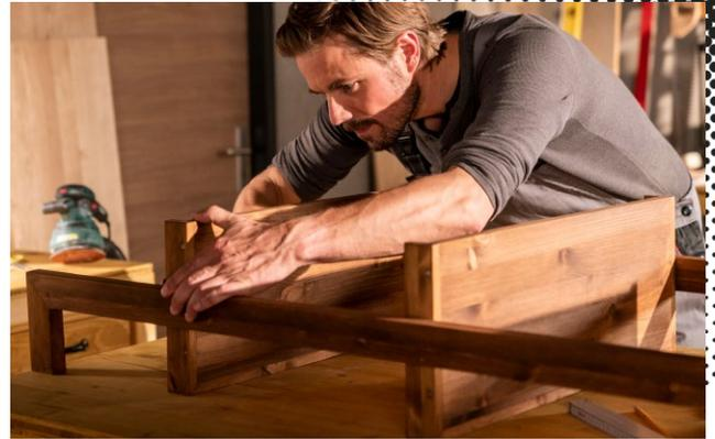
Jetzt bohrst Du mit Deinem Akkuschauber durch die Leiste in den Holm. Dann verschraubst Du Boden und Holm. So machst Du es mit jedem Boden auf beiden Seiten.
